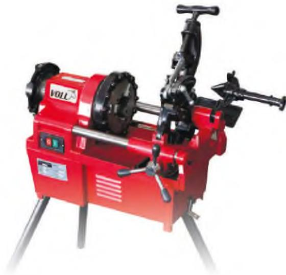
Резьбонарезные станки предназначены для нарезания наружных резьб на стальных трубах. Нарезаемые резьбы могут быть трубные цилиндрические (BSPP) или трубные конические (BSPT), в зависимости от комплектации.
