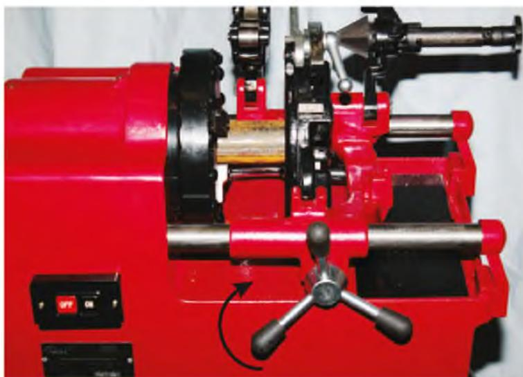
Опустите труборез на обрабатываемую деталь и включите станок выключателем. Поворачивайте рукоятку трубореза по часовой стрелке, чтобы осуществить обрезку
