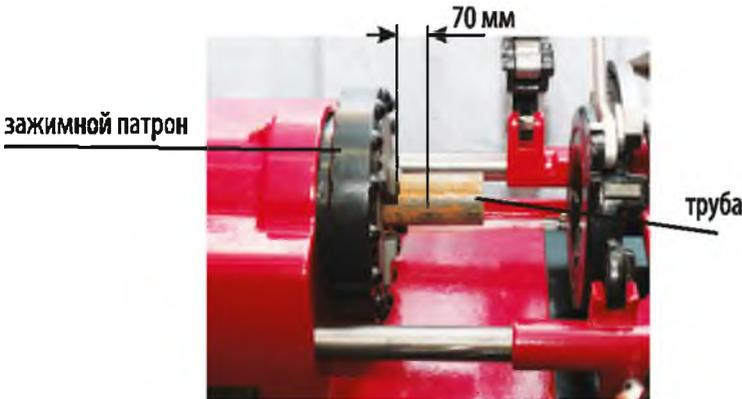
Поднимите труборез (1), резьбонарезную головку(2) и гратосниматель (3) так, чтобы они не мешали. Введите обрабатываемую деталь через центрирующий зажимной патрон (7) и затяните его.
