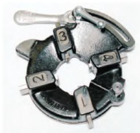
ее на горизонтальную плоскость цифрами вверх. Повернуть рукоятку против часовой стрелки до упора. Вытащить ножи.
