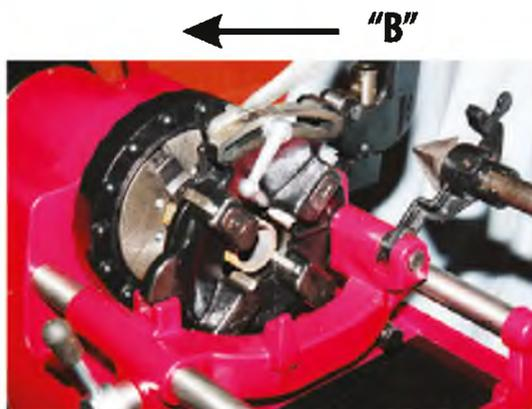
Включите станок, поворачивайте маховик по часовой стрелке, чтобы резьбонарезные ножи прижались к обрабатываемой детали.
